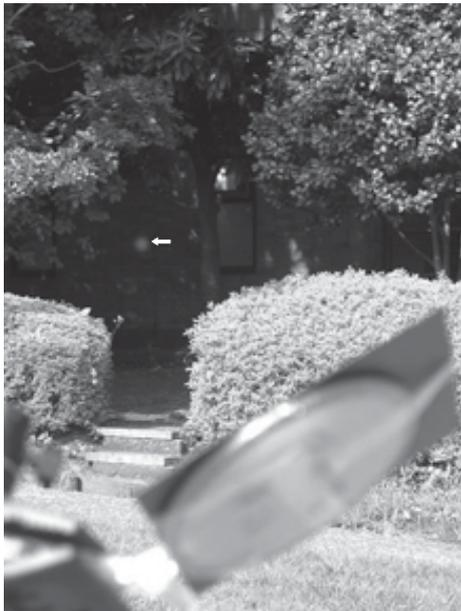
5 cmの鏡(手前)の太陽反射光が20m先の壁面で円形に
