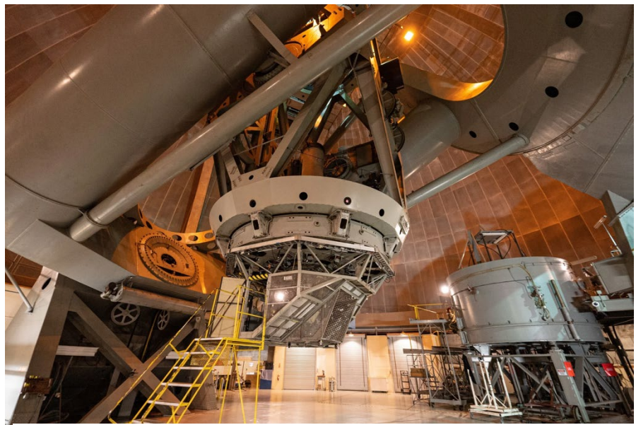
図 16. ヘール 5 m 反射望遠鏡と鏡面蒸着用チャンバー
