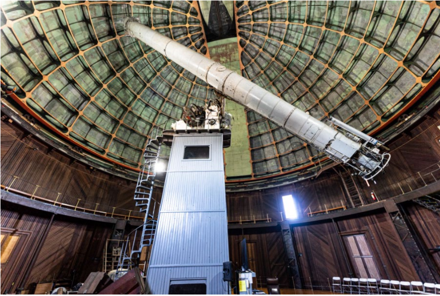
図 8. ジェームズ・リック91cm屈折望遠鏡
